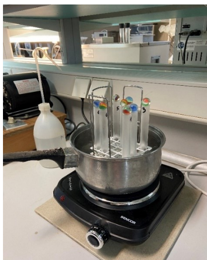
Slika 15. Uzorak sladovine sa FAN reagensom u kipućoj vodi (Izvor: autor)
