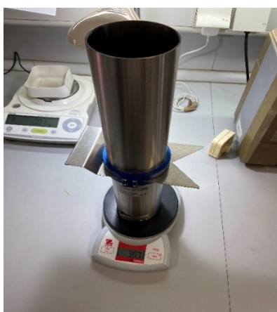
Slika 5. Uređaj za mjerenje hektolitarske mase (Izvor: autor)
