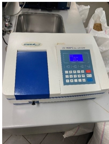
Slika 13. Uređaj za određivanje boje Spektrofotometar (Izvor: autor)
