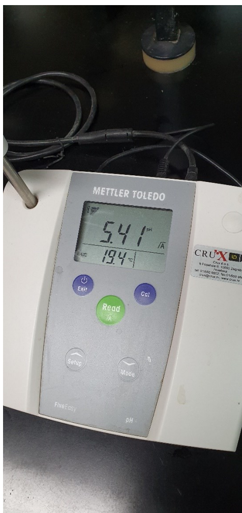
Slika 9. Mjerenje pH vrijednosti (Izvor: Autor)
