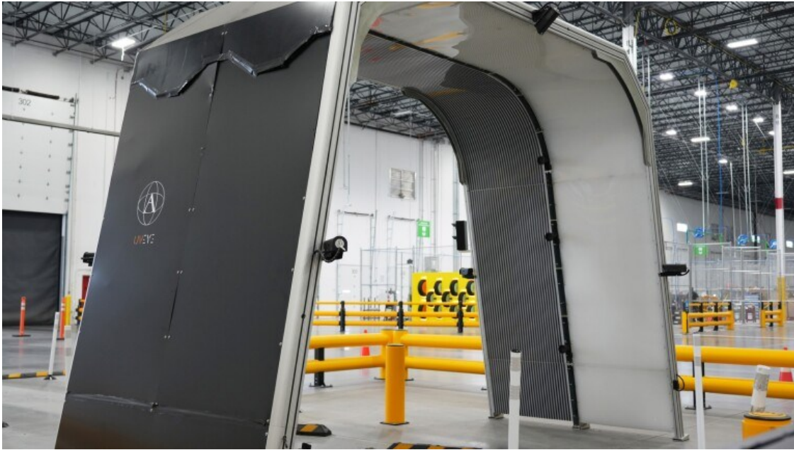
Slika 2. Prolaz za automatizirani pregled vozila
