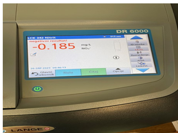
Slika 12. Uređaj za određivanje nitrata i nitrita (Izvor: autor)
