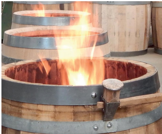
Slika 2. Paljenje drvene bačve (Bačvarija, URL)
