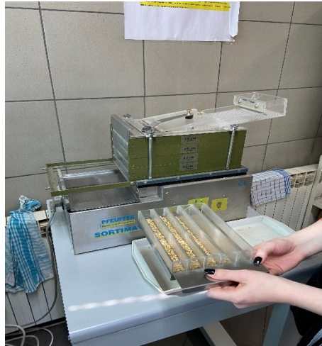
Slika 2. Razvrstavanje ječma u kalibratoru (Izvor: autor)
