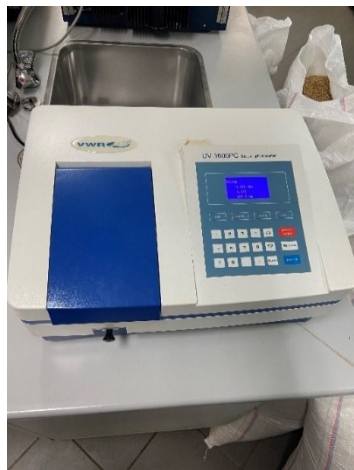
Slika 13. Uređaj za određivanje boje Spektrofotometar (Izvor: autor)
