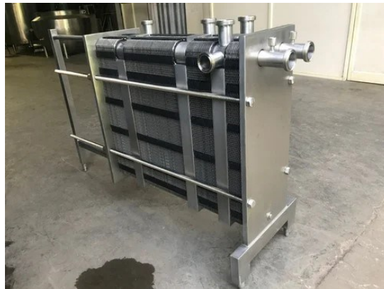
Slika 5. Pločasti izmjenjivač topline – pasterizator (m.indiamart, URL)
