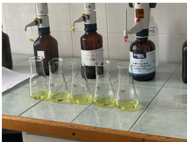
Slika 10. Određivanje klorida (Izvor: autor)
