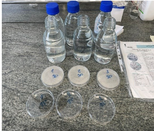
Slika 8. Određivanje broja kolonija na 36 °C i 22 °C (Izvor: autor)
