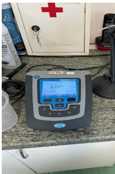
Slika 14. Uređaj za mjerenje pH vrijednosti (Izvor: autor)
