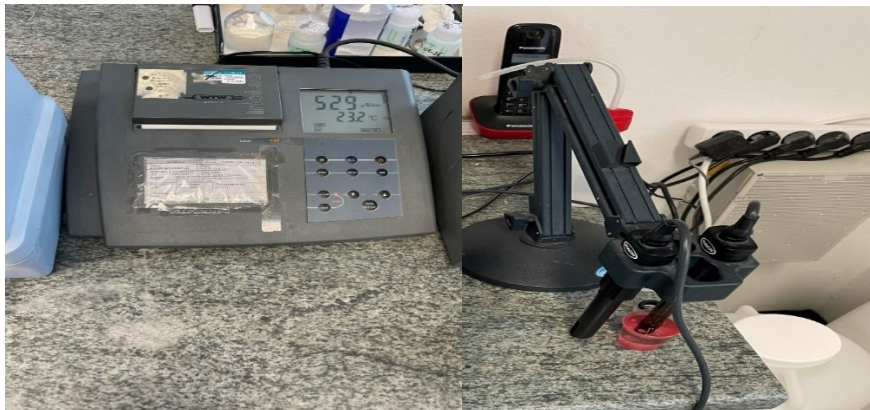
Slika 11. Konduktometar uređaj za mjerenje električne vodljivosti (Izvor: autor)
