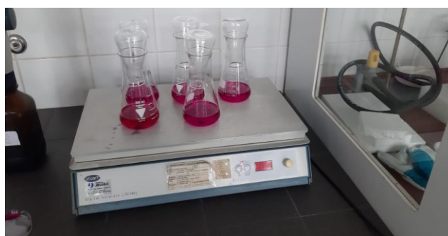
Slika 13. Zagrijavanje uzorka kalijevog permanganata (Izvor: autor)
