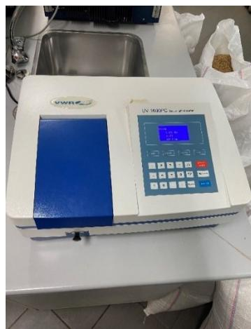
Slika 13. Uređaj za određivanje boje Spektrofotometar (Izvor: autor)
