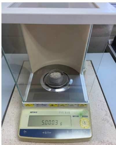
Slika 7. Analitička vaga s uzorkom slada (Izvor: autor)
