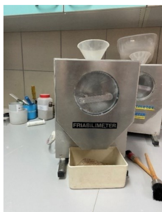
Slika 4. Uređaj za friabilnost (Izvor: autor)
