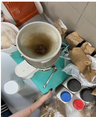
Slika 6. Mlin za sitno mljevenje slada (Izvor: autor)
