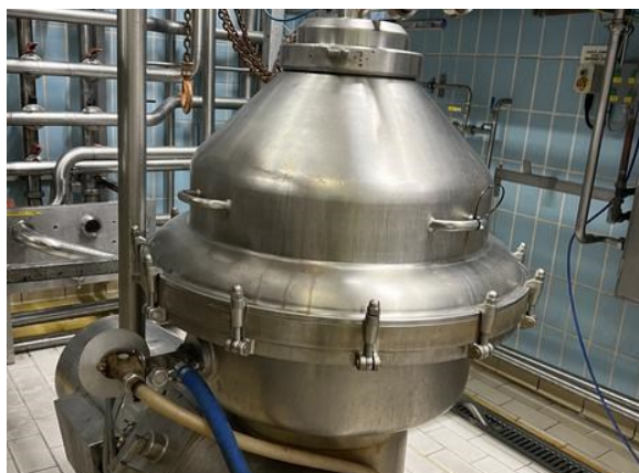
Slika 2. Separator vrhnja (exapro, URL)
