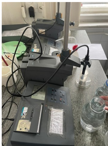
Slika 9. Konduktometar (Izvor: autor)
