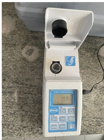
Slika 8. Turbidimetar (Izvor: autor)
