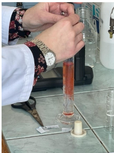
Slika 11. Određivanje aluminija (Izvor: autor)
