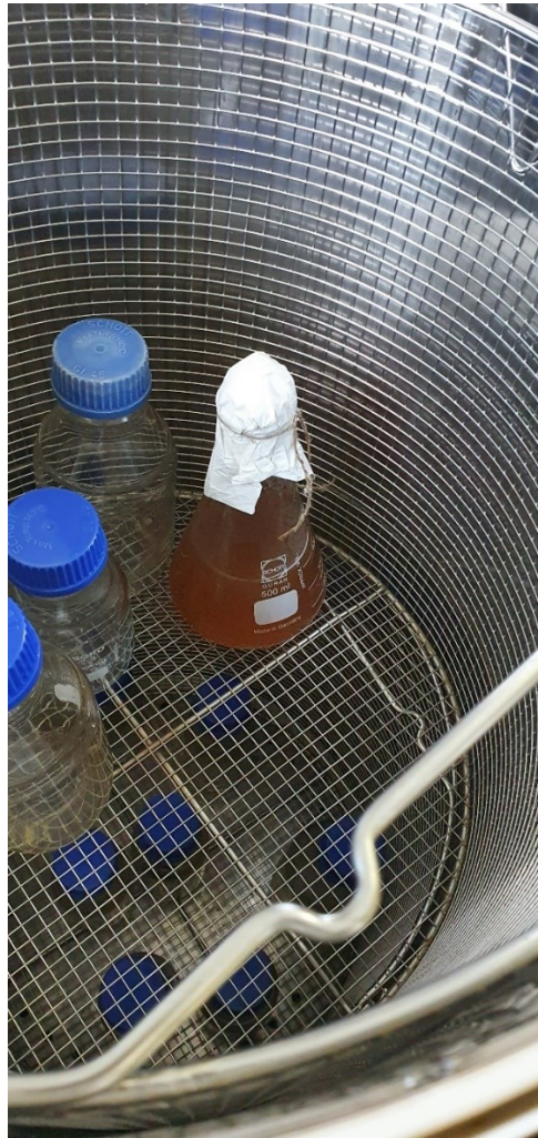
Slika 4. Sterilizacija uzorka za starter kulturu u autoklavu (Izvor: Autor)
