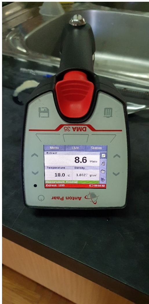
Slika 8. Mjerenje ekstrakta u uzorku prijenosnim denzitometrom (Izvor: Autor)
