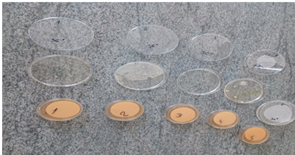
Slika 7. Rezultati određivanja ukupnog broja kolonija na 36 °C (Izvor: autor)
