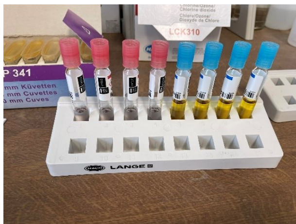
Slika 16. Određivanje željeza (Izvor: autor)
