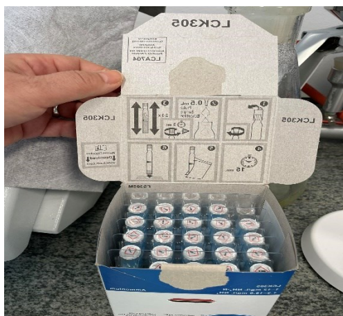
Slika 15. Kivetni testovi (Izvor: autor)
