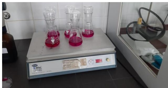
Slika 13. Zagrijavanje uzorka kalijevog permanganata (Izvor: autor)
