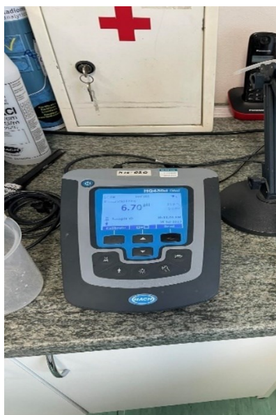
Slika 14. Uređaj za mjerenje pH vrijednosti (Izvor: autor)
