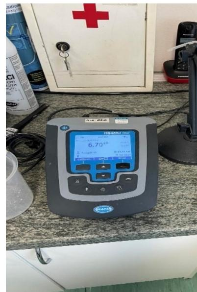
Slika 14. Uređaj za mjerjenje pH vrijednosti (Izvor: autor)
