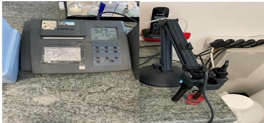
Slika 11. Konduktometar uređaj za mjerjenje električne vodljivosti (Izvor: autor)
