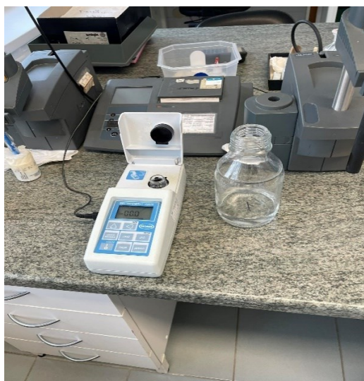
Slika 10. Turbidimetar (Izvor: autor)
